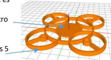
El anillo extruido es creado como el anillo del paso 2, usando diferentes valores para el radio interno y externo, y un valor diferente para la altura en el comando PRISM.
